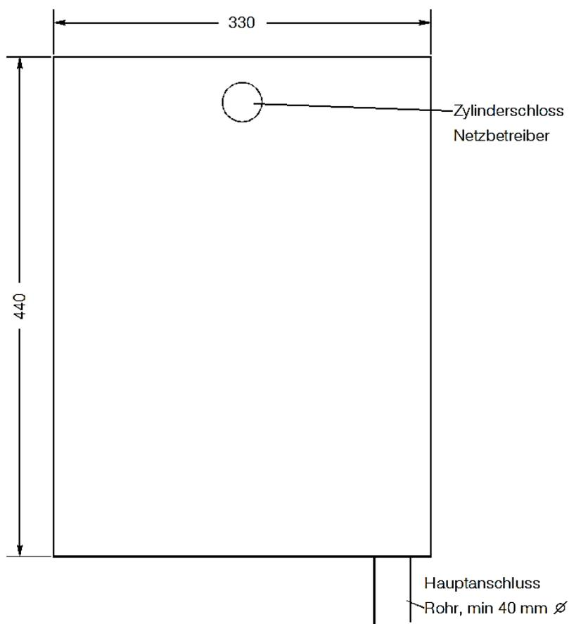
Abbildung 35 KTV-Anschlusskasten wie HAK-T/HAK-E1
