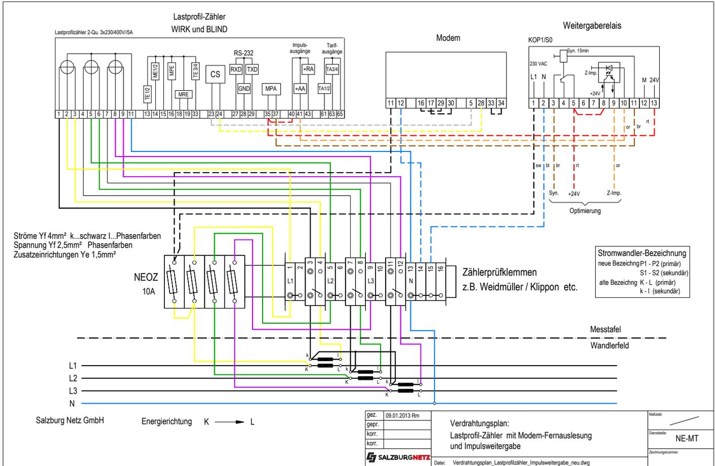
**Abbildung 25 Verdrahtungsplan Lastprofilzähler mit Modemfernauslesung und Impulsweitergabe**
