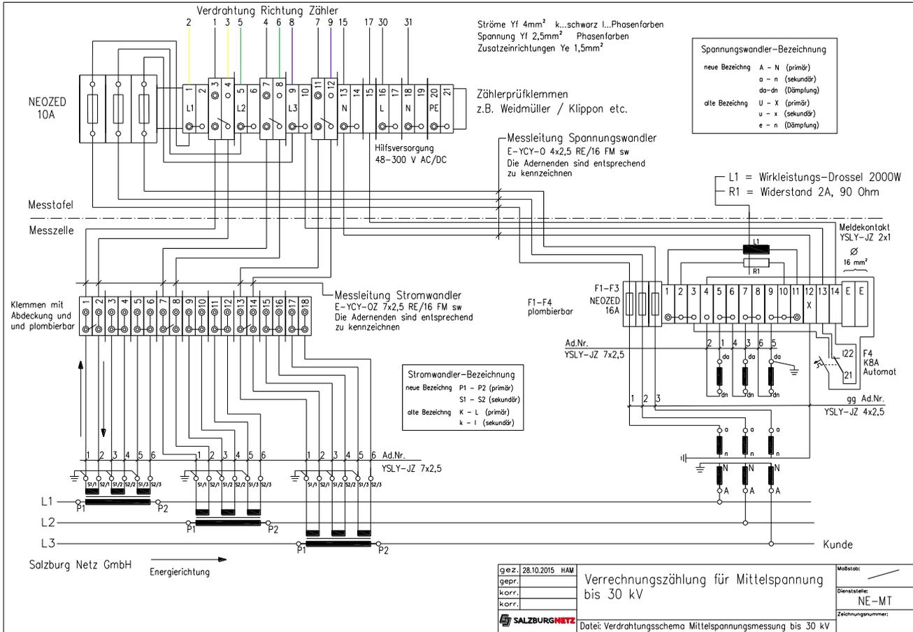
Abbildung 26 Verrechnungszhlung fur Mittelspannung bis 30 kV
