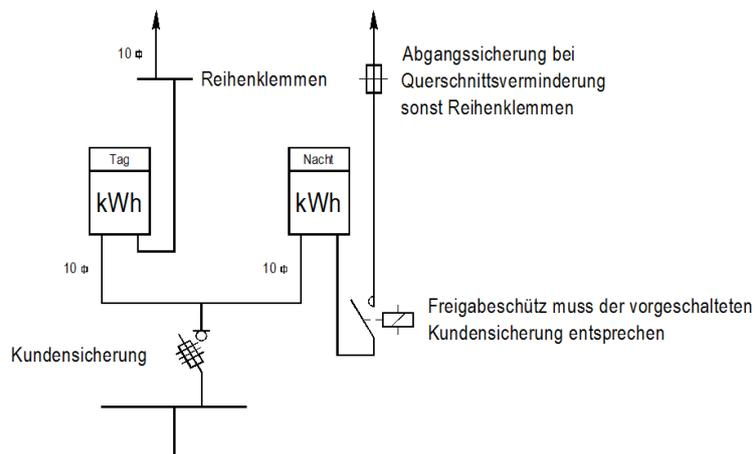
Abbildung 28 Anschluss von Heißwasserspeichern, ein- und dreiphasig
