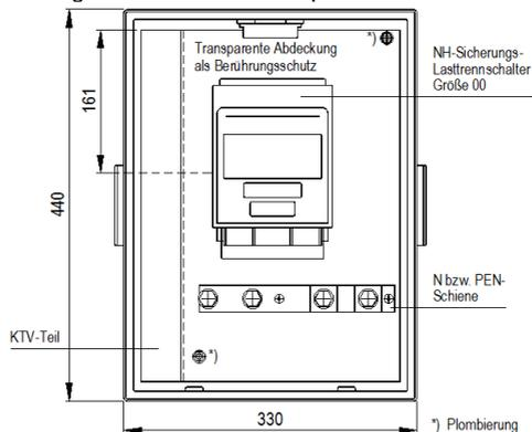
**Abbildung 2 Hausanschlusskasten HAK (330x440x150, IP44 – Darstellung ohne Stecktür)
