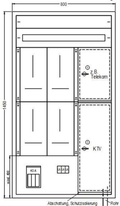
① Kunststoffriegel, einfacher Austausch auf Blechmontagezylinder möglich (z.B.: 00033, 00043)
